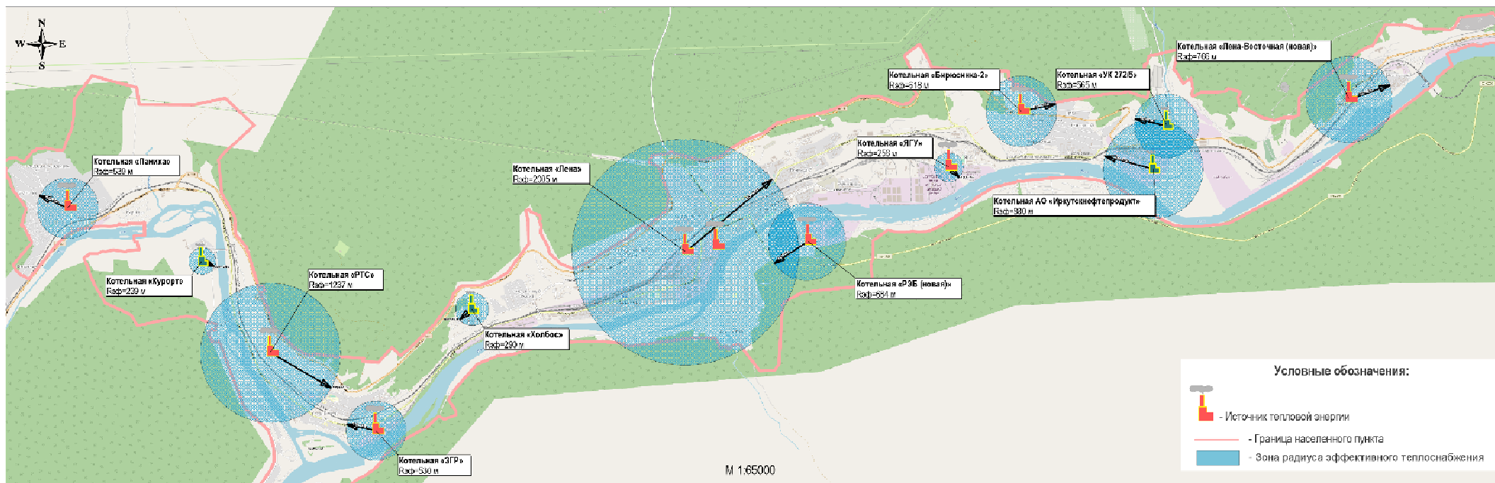
Рис. 2.10. Схема существующих радиусов эффективного теплоснабжения от источников МО «город Усть-Кут».
