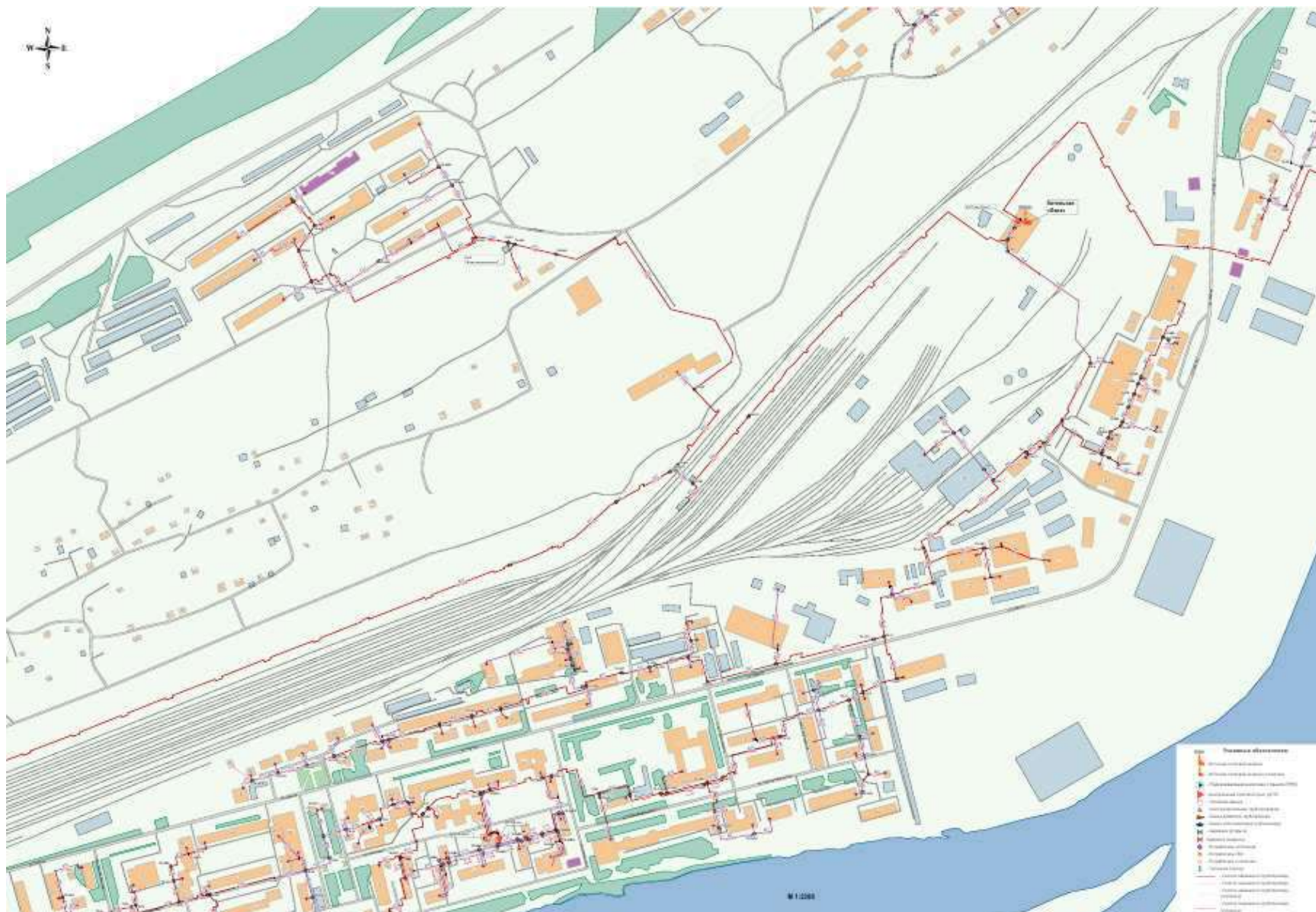
Рис. 1.21. Существующая схема тепловых сетей в зоне действия котельных «Лена» и «Центральная» в мкр. «Железнодорожник», «ЦГР» и «Лена».
